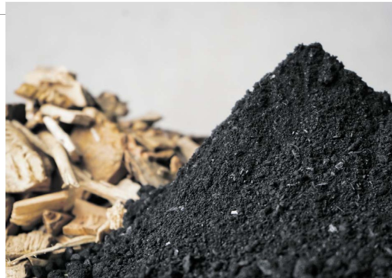
Der Rohstoff des grünen Betons ist Kohle aus Waldabfällen. © Syncraft
